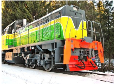
Маневровый тепловоз с Li-Ion аккумуляторами ТЭМ9Н
