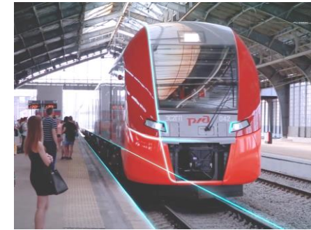
Электропоезд «Ласточка» с элементами системы автоведения (GoA3+)
